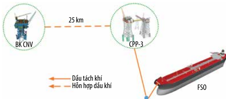
Hình 4. Sơ đồ vận hành mỏ Cá Ngừ Vàng kết nối với mỏ Bạch Hổ.
