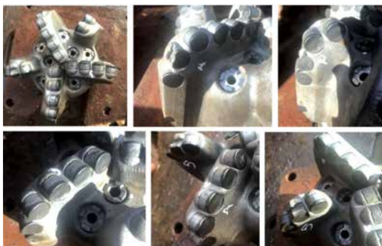
Hình 12. Tình trạng chòong kéo lên ở giếng khoan 2207 BK-22.
