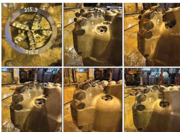
Hình 11. Tình trạng chòong kéo lên ở giếng khoan 2202 BK-22.
